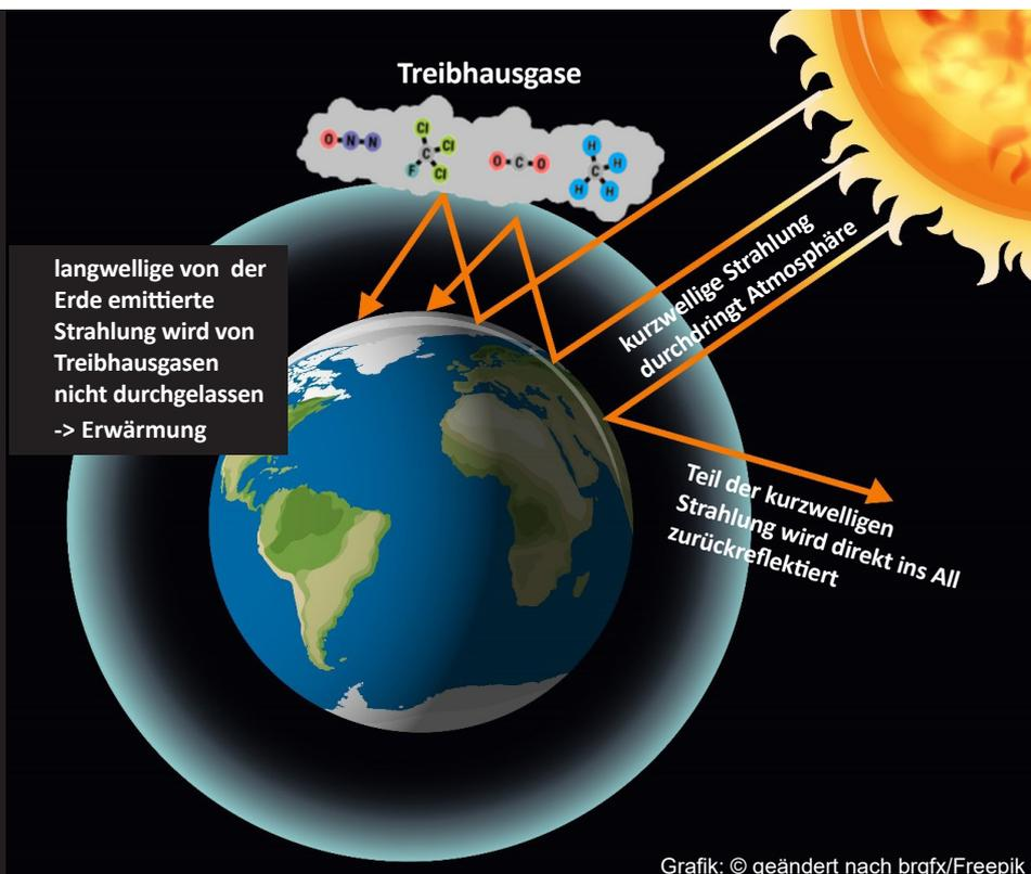
Abbildung 1: Schematische Darstellung der wichtigsten Prozesse beim Treibhauseffekt.
